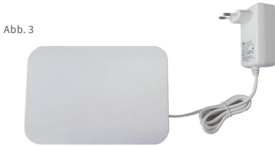
Gateway mit Steckernetzteil
